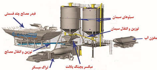
شکل ۱۱- اجزای یک بچینگ افقی
