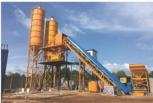
شکل ۱- ایستگاه پیمانانه کردن عمودی
