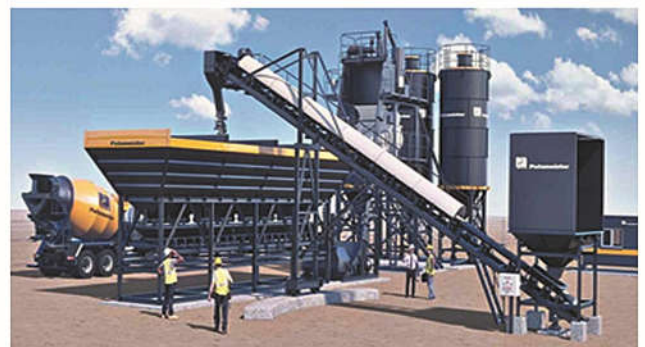
شکل ۵- نمونه های از بچینگ پلانت ثابت
