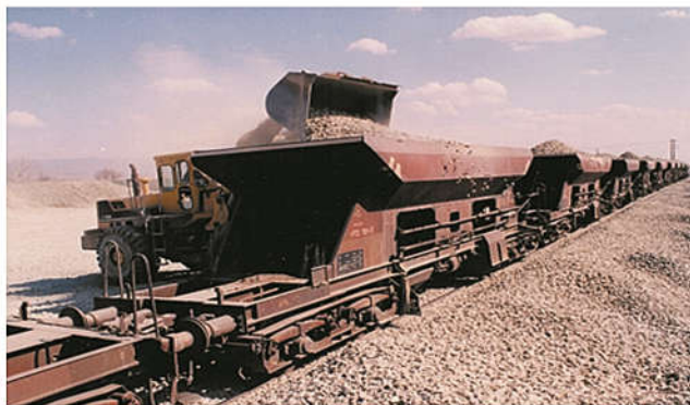
شکل ۱۳- ریل و واگن حمل مصالح کارگاهی
