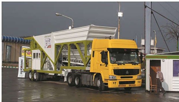
شکل ۶- نمونه هایی از بچینگ سیار
