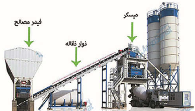
شکل ۲- شماتیک بچینگ افقی
